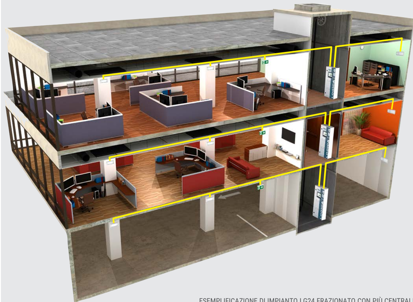
ESEMPLIFICAZIONE DI IMPIANTO LG24 FRAZIONATO CON PIÙ CENTRALI
